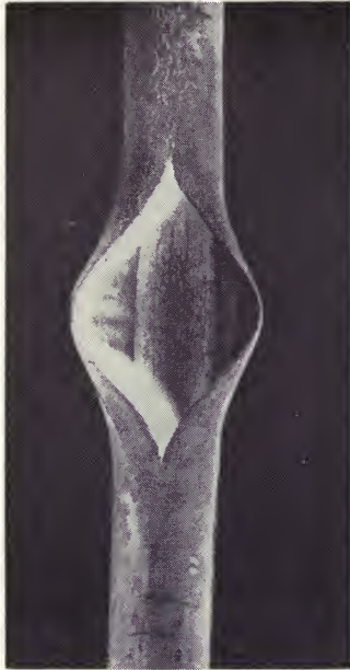
FIG. 10. Tube failure due to analcite scale.
